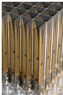
ANTENNA ARRAY VIVALDI
